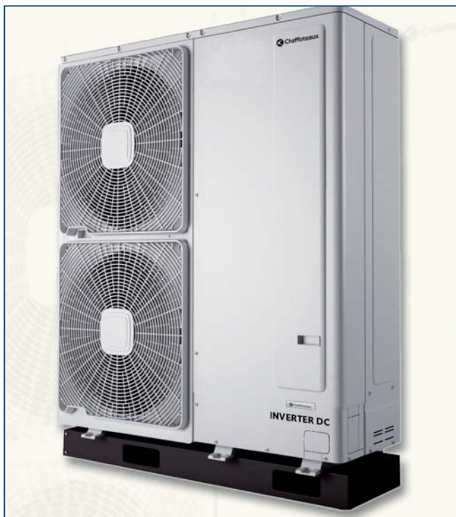
Photo Chaffoteaux : La nouvelle Pac Aeropur de Chaffoteaux illustre bien le nouveau standard du marché français pour les pompes à chaleur : une machine air/eau monobloc externe, utilisant le R410A et offrant une température de sortie d'eau de 55 °C jusqu'à -10 °C.
